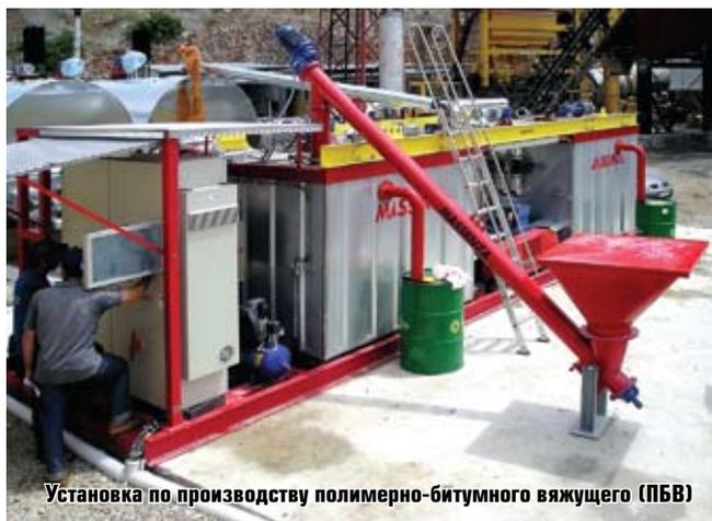
Установка по производству полимерно-битумного вяжущего (ПБВ)
